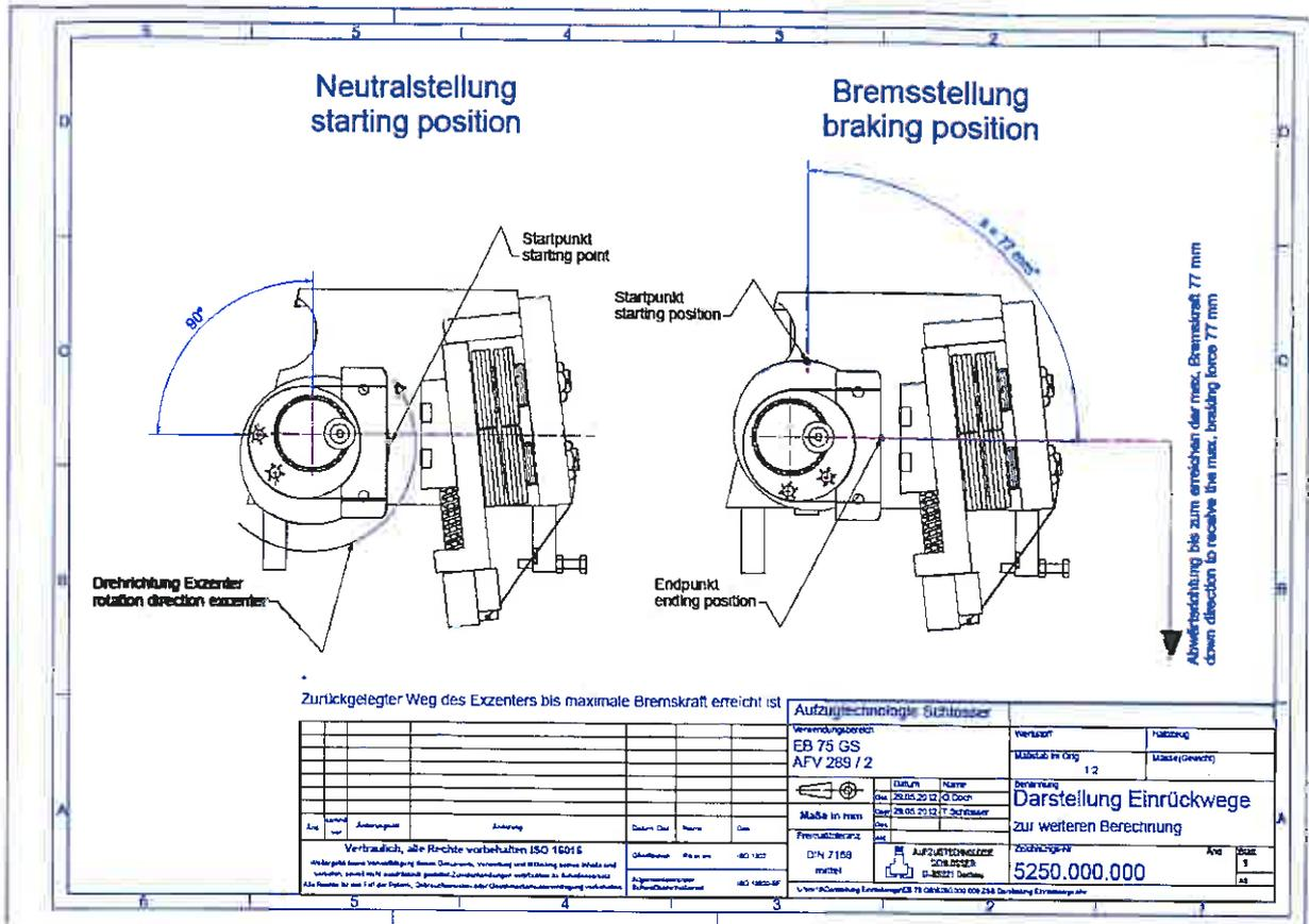
**Anhang 2 : Die Aktivierung Abstand von EB 75 GS Fangvorrichtung in Richtung nach oben mit Schlosser Aktivierungsmechanismus angewendet (Kombination mit KB55S).**
