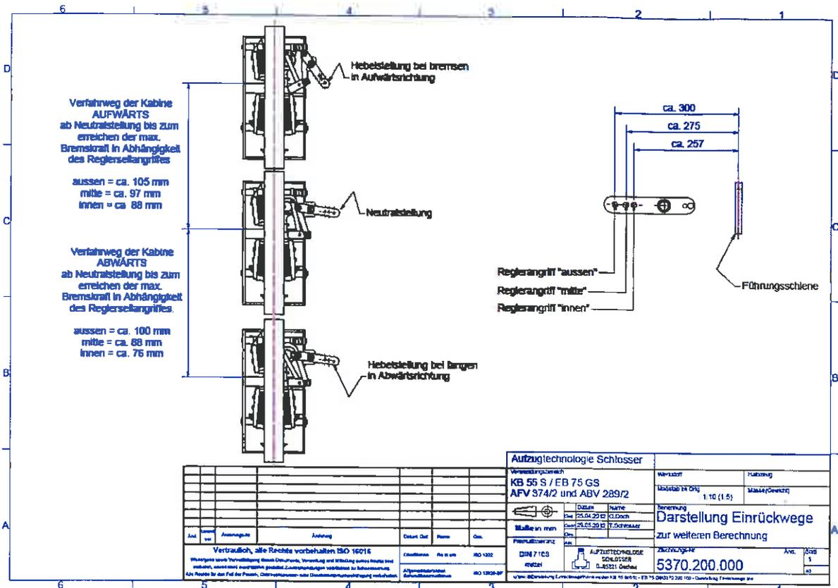
**Anhang 3 : Die Aktivierung Abstand von EB 75 GS Fangvorrichtung in Richtung nach oben mit Schlosser Aktivierungsmechanismus angewendet (Kombination mit KB55SS).**
